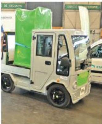
La nouvelle création de Libner pour transporter les rolls depuis le camion jusqu'au point final. La capacité de charge est de 300 kg. Les pédales ne servent qu'à donner l'élan initial. C'est la poignée tournante côté droit du guidon qui fait fonction d'accélérateur. La capacité de charge est de 300 kg. Ce nouvel engin devrait porter le nom de Tri-Bil.
