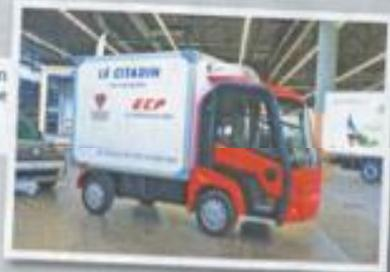
**N**ouvel aménagement pour le Colibus, en fourgon sec ou réfrigéré, avec un agencement très américain dans le style des step-in vans UPS. Le constructeur a déplacé les batteries à l'arrière, entre les roues mo-
